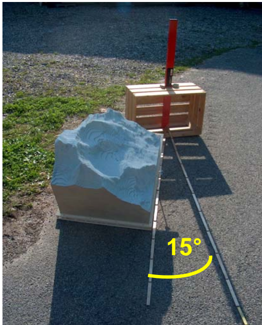
Abb. 29: Der Winkel zwischen dem Schattenwurf der Wasserwaage und der Ausrichtung des Modells beträgt 15°
