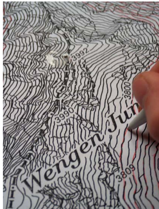
Abb. 17: Übertragung der Höhenlinien auf die Holzplatten
