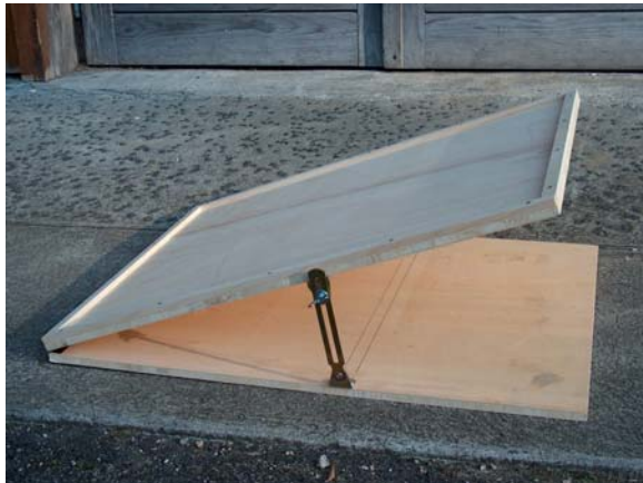
Abb. 24: Hilfskonstruktion zur Herstellung des Neigungswinkels
