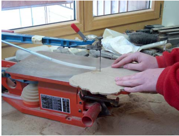
Abb. 18: Aussägen der Platten mit dem Decoupiersägel
