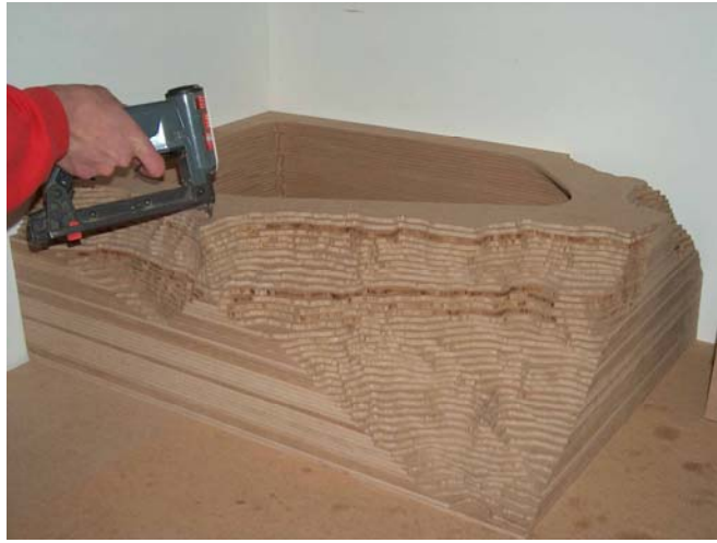
Abb. 21: Das aufeinander Nageln der Platten mit Hilfe eine Pressluft-Nagelpistole
